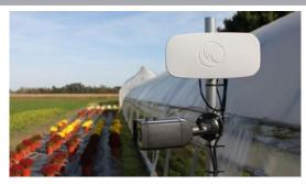
Das Gehäuse verfügt über den Schutzgrad IP55 beziehungsweise IP67. So können die Geräte sowohl im Innen als auch im Außenbereich eingesetzt werden.
